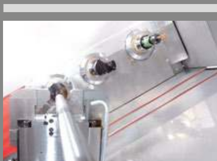
Automatisierte Werkzeugmaschine zur Endenbearbeitung von Lenkzahnstangen.
