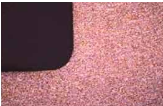
Band mit eingefräster Stufe, spannungsfreies Gefüge
