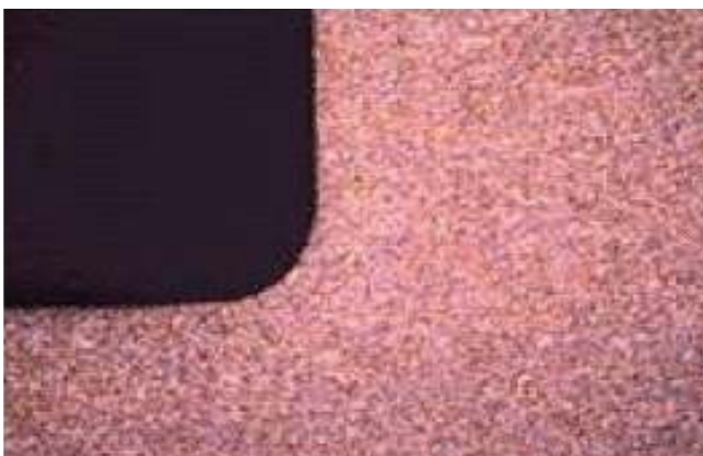
Band mit eingefräster Stufe, spannungsfreies Gefüge
