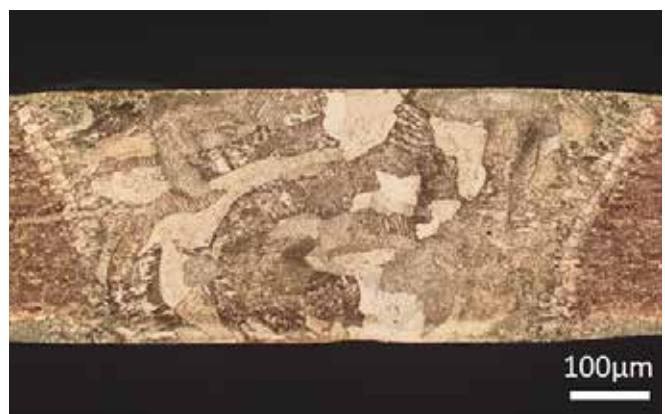
Abbildung 10 – WIG-Naht ohne Zusatzwerkstoff in Wieland-K65 WIG-Nähte werden meist zur Verbindung von Bändern als Transportnähte vor der Weiterverarbeitung verwendet und dienen so der Verminderung von Rüstzeiten und der Erhöhung der Produktivität beim Stanzen und Beschichten. Die Transportnähte werden nach den Stanz- bzw. Beschichtungsprozessen wieder entfernt. WIG-Schweißnähte werden kaum/nicht als Fügestellen in einer elektronischen Komponente selbst eingesetzt
