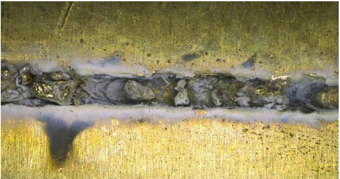
Abbildung 19 – Laserschweißnaht in CuZn37
