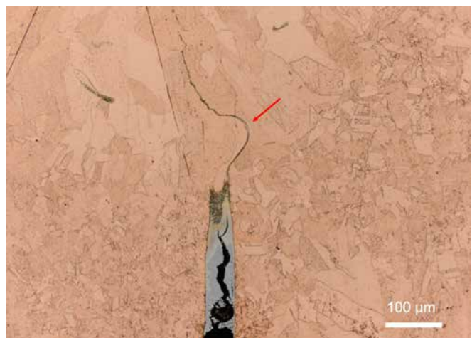
Abbildung 20 – Zinnschliere in einer Nahtwurzel beim Verschweißen von verzinntem Reinkupfer
