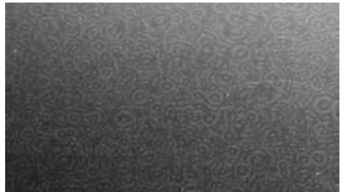
REM-Aufnahme der Oberfläche einer SnTEM-Beschichtung
