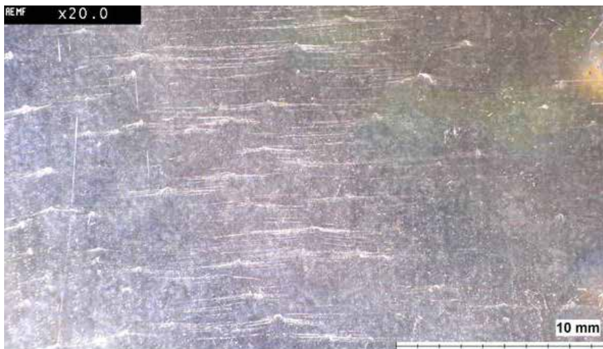
Beispiel: B14; 0,315mm; 1–3µm Zinnschichtdicke; SnPUR (Abblasrichtung vertikal)
