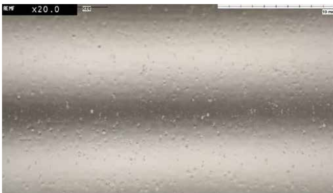
K73; 0,246mm; 1–3µm Zinnschichtdicke; SnPUR
