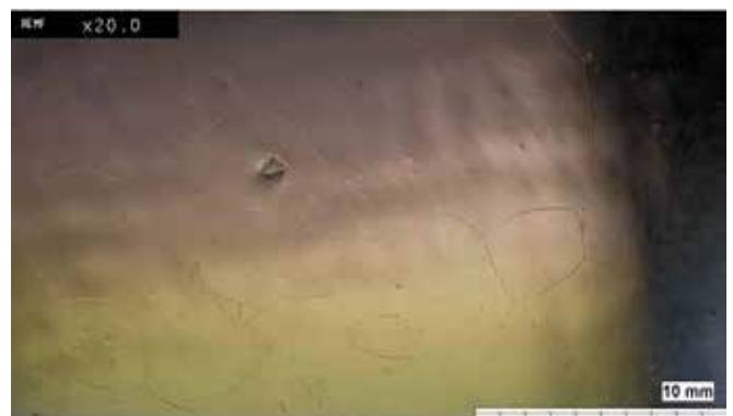
Einzeln auftretende Vertiefung als Folge einer Entnetzung
