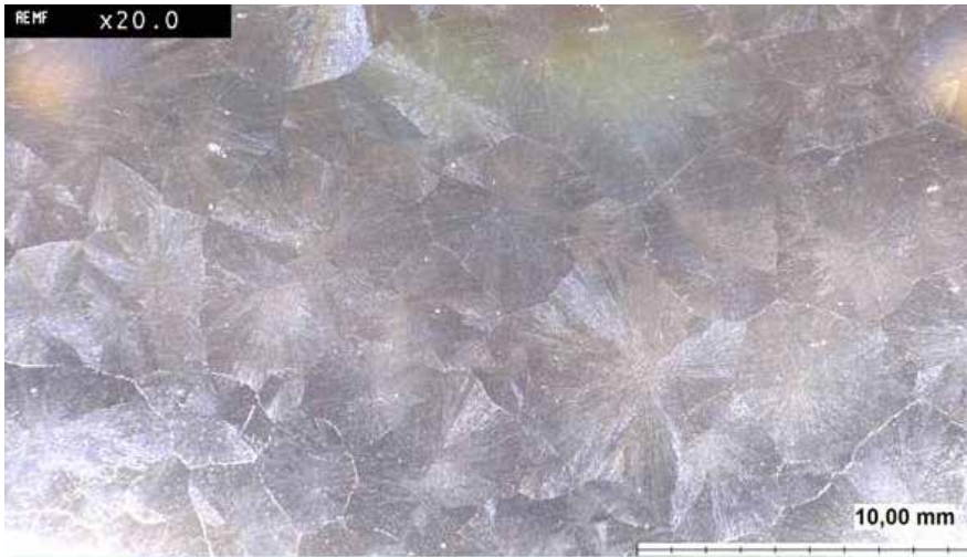
K81; 0,2mm; 1–3µm Zinnschichtdicke; SnTOP
