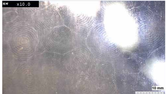
Dickverzinnung mit typischer Kreisstruktur
