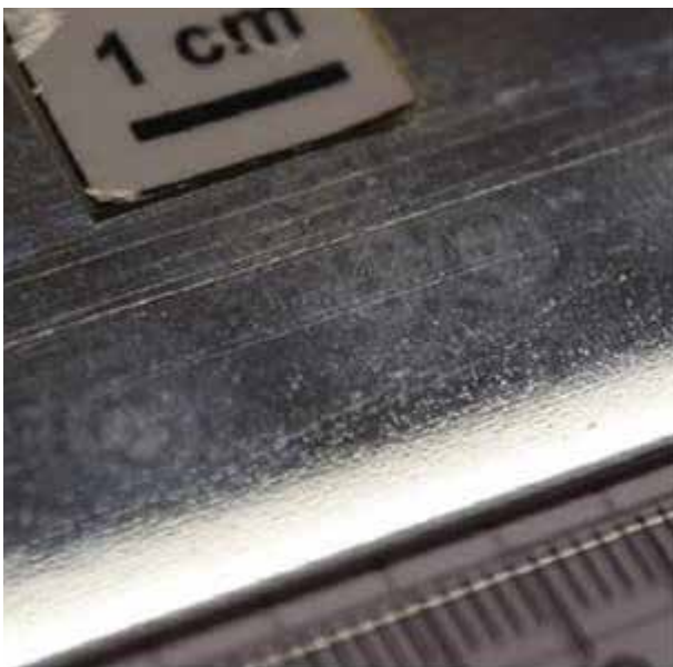
Optisch sichtbare Kratzer innerhalb der Toleranzen
