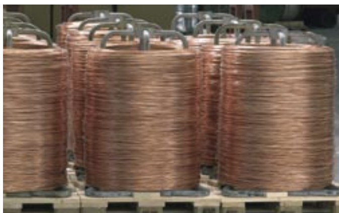
Auf Kronenstöcke gewickelter Draht
