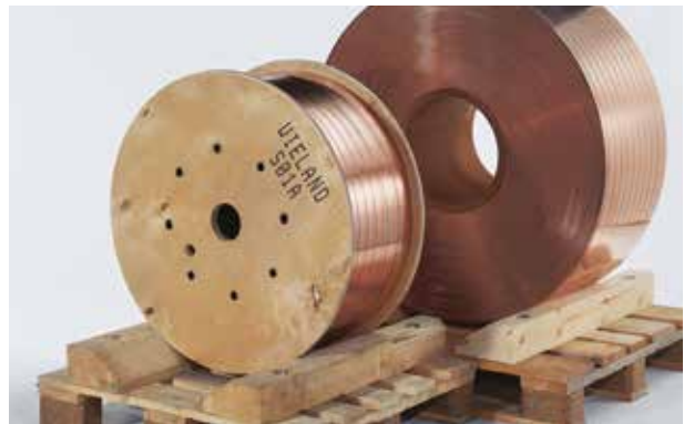
Abb. 9: Spulen mit und ohne Flansch
