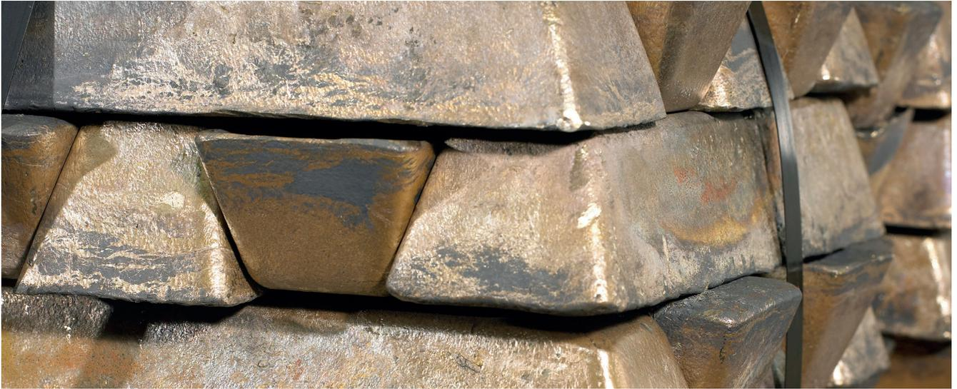
Das Sondermessing ECOCAST wurde speziell für die Anforderungen von Giessereien entwickelt.
