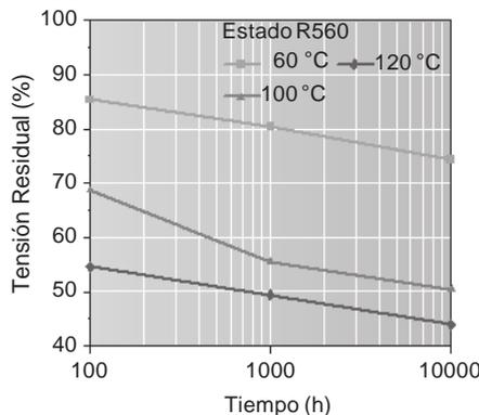
La tensión residual en función del tiempo y la temperatura deservicio. Medido paralelo a la dirección de laminación. Valores extrapolados según F. R. Larson, J. Miller, Trans ASME74 (1952) 765-775
