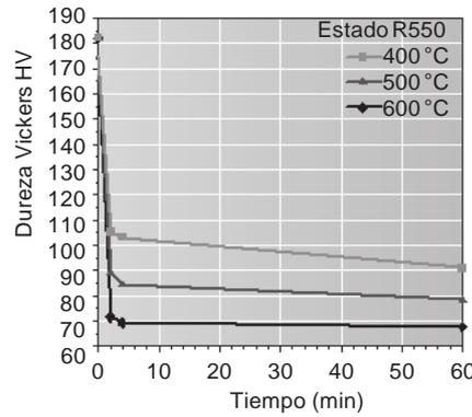
Dureza Vickers tras tratamiento en caliente (valores típicos)
