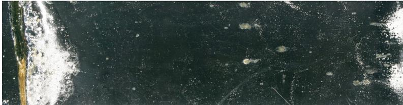
Abb. 8: Wieland-K75 (CuCrSiTi) 0,4 mm mit 2–4 µm dicker Feuerverzinnung nach Durchführung des Lötbadtests gemäß DIN EN IEC 60068-2-20 mit bleihaltigem Lot SnPb40 (oben) und bleifreiem Lot Sn96,5Ag3Cu0,5 (unten)
