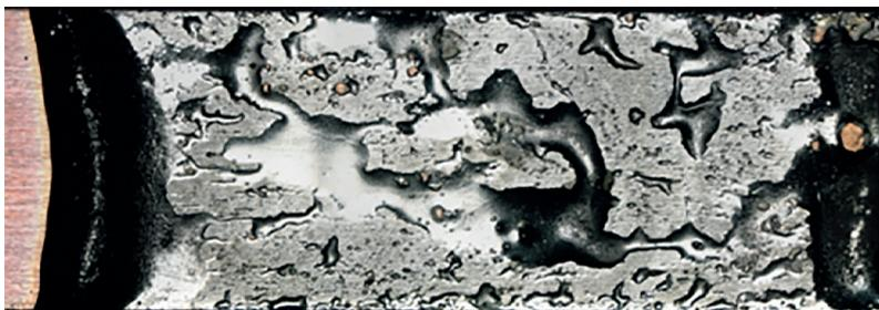
Abb. 6: Wieland-K75 (CuCrSiTi) 0,6mm mit einem Lotüberzug der Ausprägungsform C
